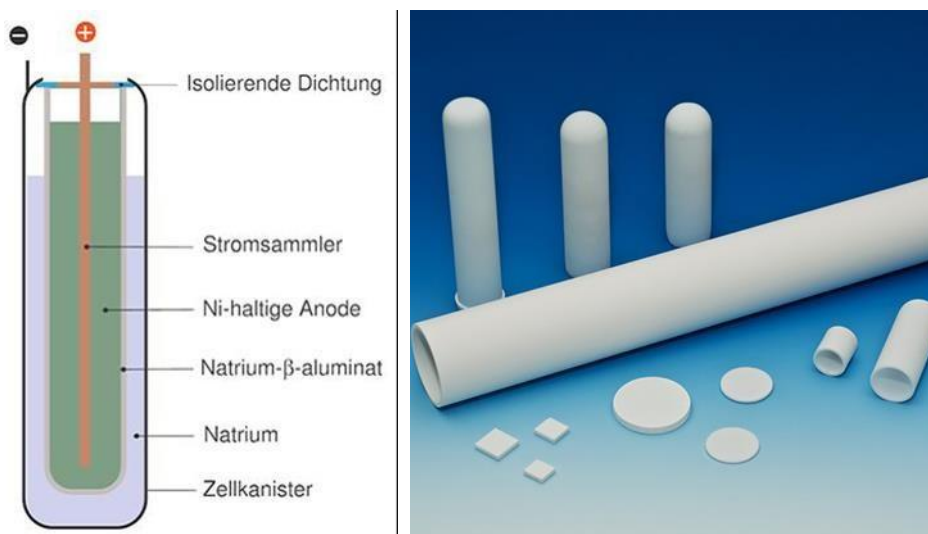
Abbildung 1: Schematischer Aufbau einer Na/NiCl 2 Zelle (links); Na β Aluminat Festkörperelektrolyte aus Na-β-Aluminat (Bildquelle: Fraunhofer IKTS)
