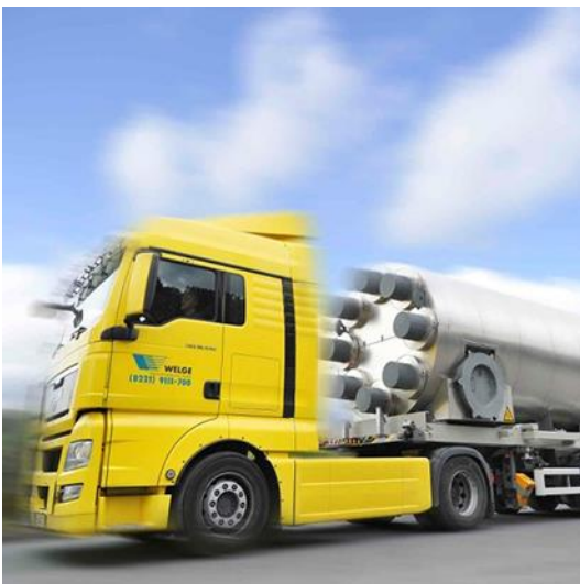
Abbildung 3: Mobiler Sorptionsspeicher zur Abwärmenutzung in Hamm /NRW
