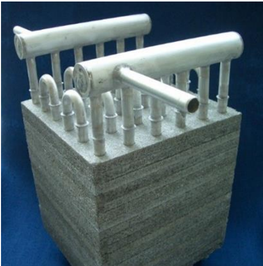
Abbildung 2: Hochleistungs-Latentwärmespeicher (ohne Gehäuse) mit Aluminium-Faserstruktur zur Erhöhung der Wärmeleitung. Labormodell: Bauvolumen 10 l, Dauerleistung 2 kW, Peak-Leistung 10 kW.
