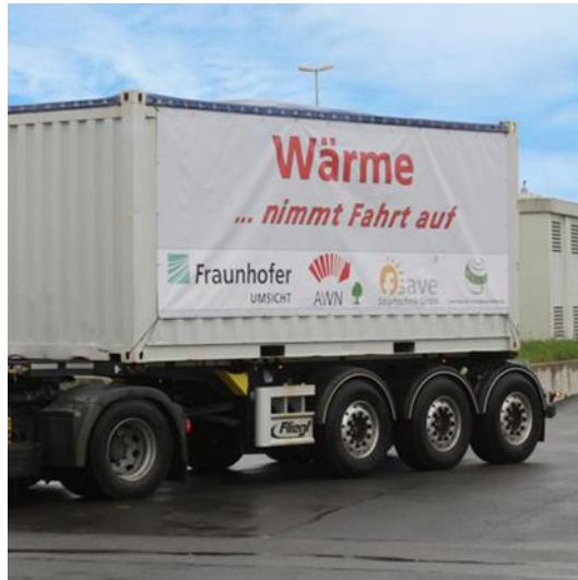
Abbildung 3: Abwärmennutzung mit mobilem Latentwärmespeicher bei der Abfallwirtschaftsgesellschaft des Neckar-Odenwald-Kreises mbH (AWN)
