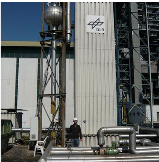
Abbildung 1: Latentspeichermodule mit 700 kW Leistung, Speicherkapazität 1h. NaNO 3 als Speichermedium, Phasenwechsel bei 305 °C
