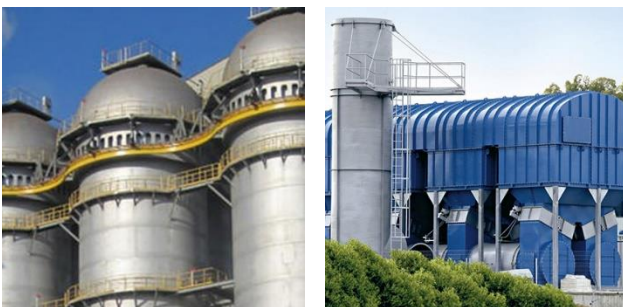
Abbildung 1: Winderhitzer im Hochofenprozeß (links), Thermisch-oxidative Abluftreinigung (rechts). Quelle: [1](links), [7](rechts)
