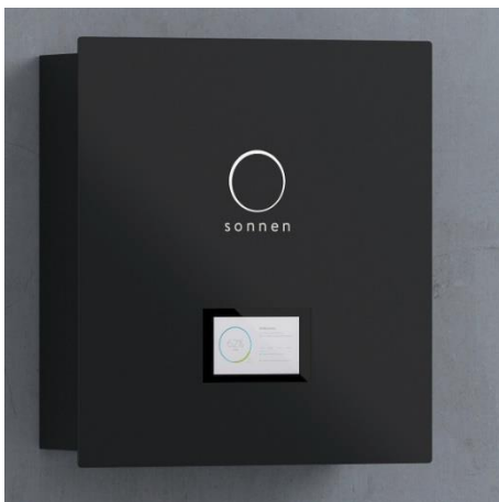
Abb. 2: Heimspeicher zur Erhöhung des solaren Eigenverbrauchs und zur Integration in den Strommarkt: sonnenBatterie eco 8.2 mit 8kWh Kapazität und 1,5kW Leistung; Bildquelle: sonnen GmbH
