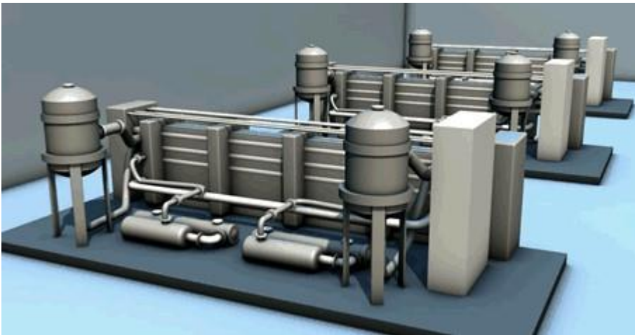
Abbildung 2: PEM Elektrolyse (6 MW) – Energiepark Mainz
